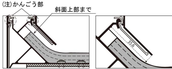
(注)かんごう部への防水材の付着にご注意ください。また防水完了後、本体(カバー)材を取り付けるまで時間があく場合は踏みつけや、塗料の付着にご注意ください。変形や汚損すると、かんごう不良の原因となり、カバー材の脱着事故に繋がります。
